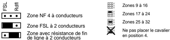
Figure 14. Positions du cavalier pour sélection du type de connexion et adressage des zones
